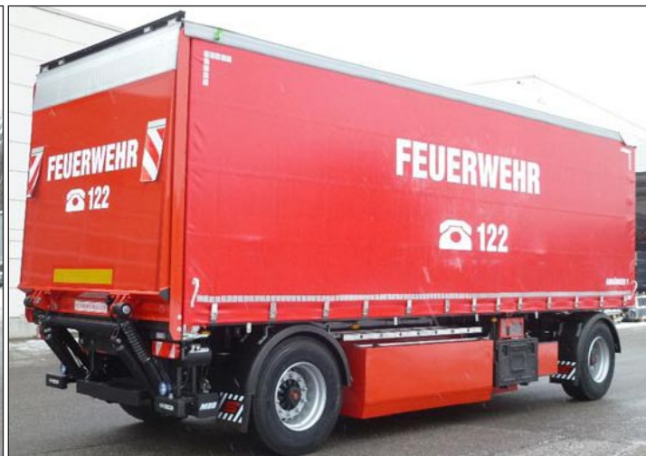
Fahrgestell: 2 Achs Schiebepalen- Plateauanhänger Abnahme: 18.01.2013 bei der Fa. Schwarzsmüller
